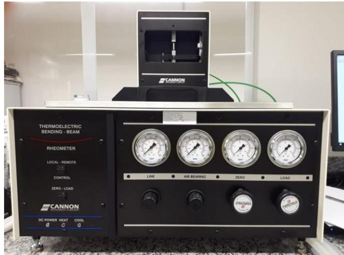
Figura 15 - Reômetro de fluência em viga do GEPPASV/UFSM
