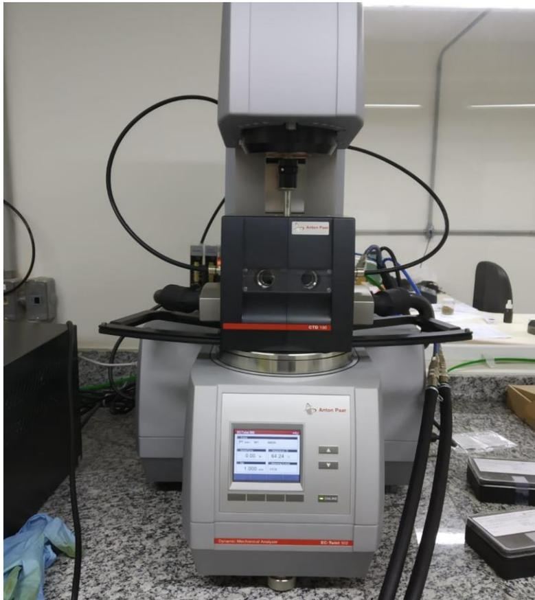
Figura 11 - Reômetro de cisalhamento dinâmico do GEPPASV/UFSM
