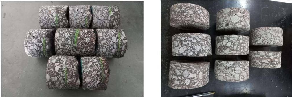
**CPs EM CONDICIONAMENTO EM ESTUFA ATÉ COSTÂNCIA DE PESO PARA ENSAIO DE DENSIDADE APARENTE**
