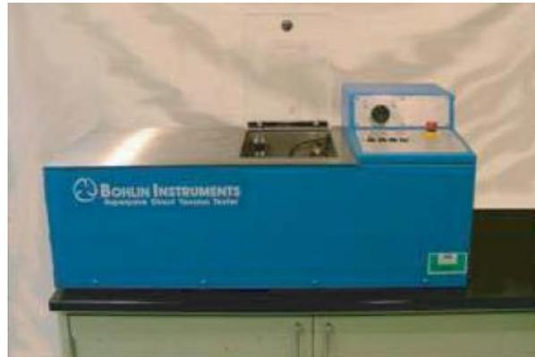
Figura 18 - Equipamento para realização do ensaio de tração direta
