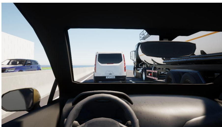
Figura 10 - Representação 3D RSC-287 vista do condutor com barreira dupla ou lateral próxima à barreira simples.
