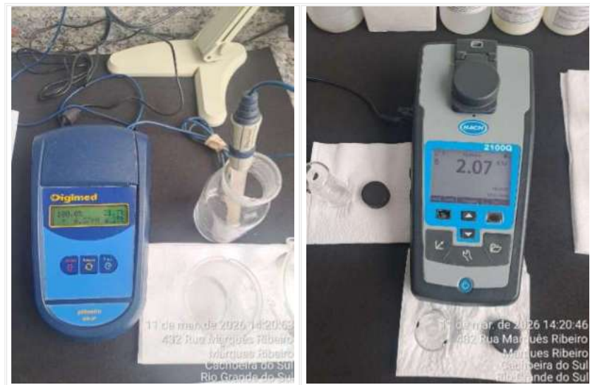
Figura 15 - Equipamentos sem certificado de calibração
