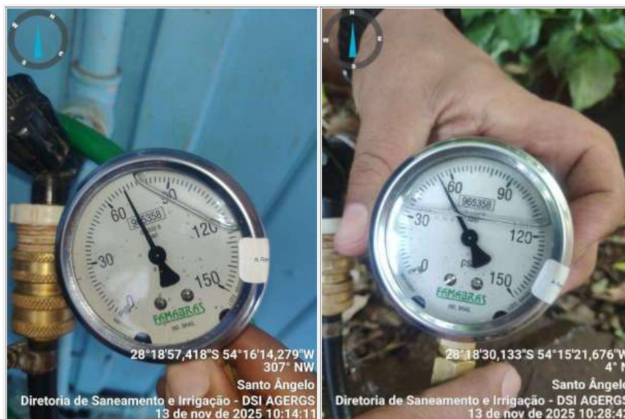
Figura 28 - Pressões em desconformidade com a normativa AGERGS.
