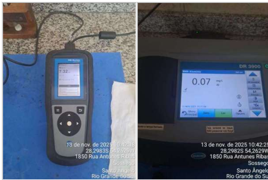
Figura 13 - Equipamentos de análises sem certificado de calibração.
