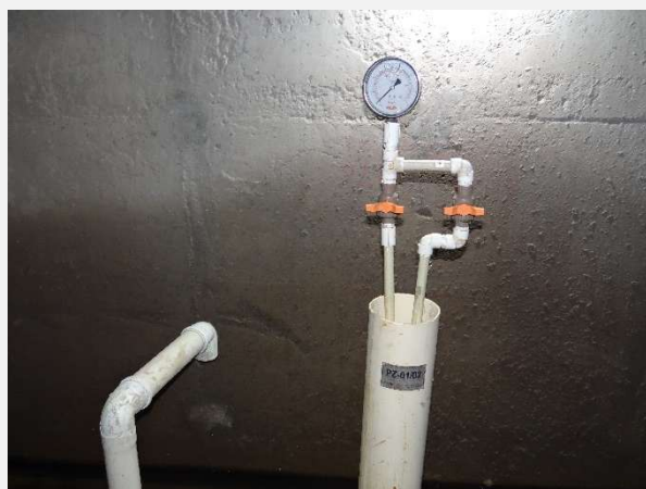
Galeria de Drenagem da Barragem - Piezômetros com manômetros inoperantes.
